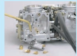
9. Mit Druckluft die Bohrungen freipusten.
