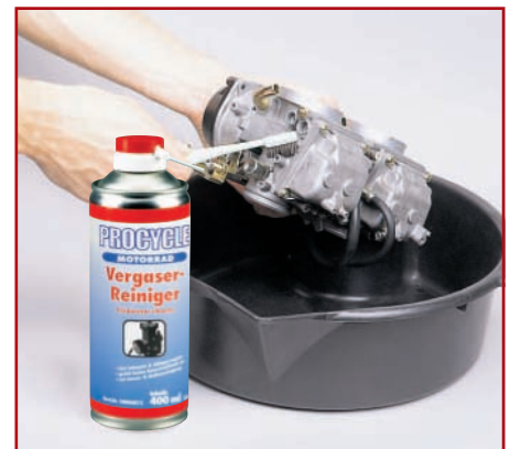
4. Vergaser äußerlich reinigen
