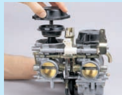
7. Unterdruckkolben ausbauen und prüfen.
