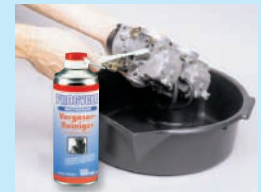
4. Vergaser äußerlich reinigen.
