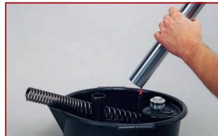
3. Obere Gabelverschlusschraube entfernen und Gabelöl ausgießen
