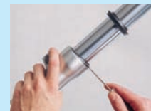
4. Untere Gabelverschlossschraube entfernen. Beim Zusammenbau unbedingt Dichtring erneuern.
