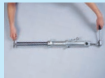
4. Untere Gabelverschlossschraube entfernen. Beim Zusammenbau unbedingt Dichtring erneuern.
