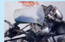
8. 100% gleiche Mengen Gabelöl in der richtigen Viskosität einfüllen.
