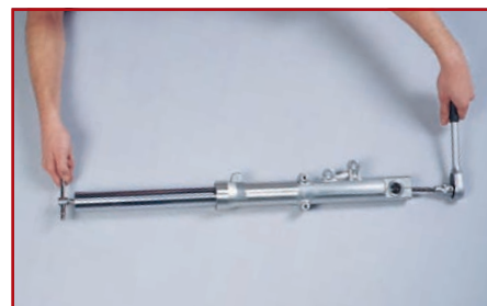
4. Untere Gabelverschlusschraube entfernen
