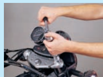
1. Erst die Klemmungen der oberen Gabelbrücke, dann die Verschlossstopfen lösen.
