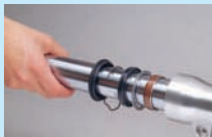
6. Mehrmals ruckartig am Standrohr ziehen.
