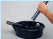
3. Obere Verschlossschraube, Gabelfedern etc. entfernen und altes Gabelöl auskippen.
